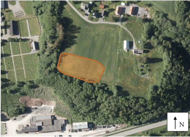
Figur 6 Flyfoto over Hegramo (kilde: Norge i bilder), M 1:3300. Orange område illustrerer omtrent område som må sikres med kalksement for å øke sikkerheten mot kvikkleireskred.
