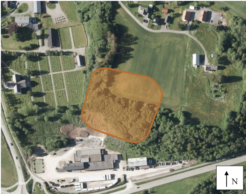
Figur 7 Flyfoto over Hegramo (kilde: Norge i bilder), M 1:3300. Orange område illustrerer omtrent område som må sikres med saltbrønner for å øke sikkerheten mot kvikkleireskred.
