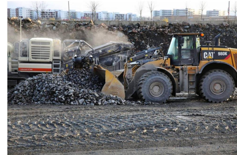
SPARER MILJØET: Stein, jord, asfalt og betong gjenbrukes på Fornebu. I dette «steinbruddet» blir brukte masser forvandlet til ny singel og pukk i knusemaskin...
