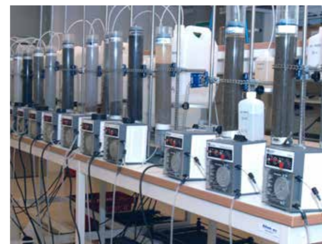
Utlekkingsegenskaper av et materiale kan testes i kolonneforsøk.
