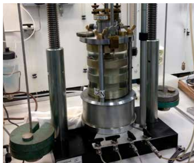
Skjærfasthet og permeabilitet i et materiale kan testes og dokumenteres i en triaxelle.
