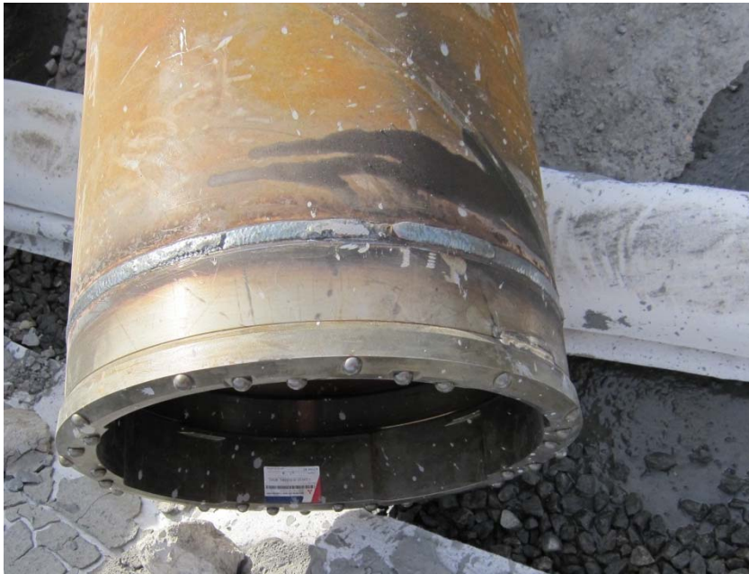
Figur 12: Ringborkrone og boresko som er sveiset til stålrøret
