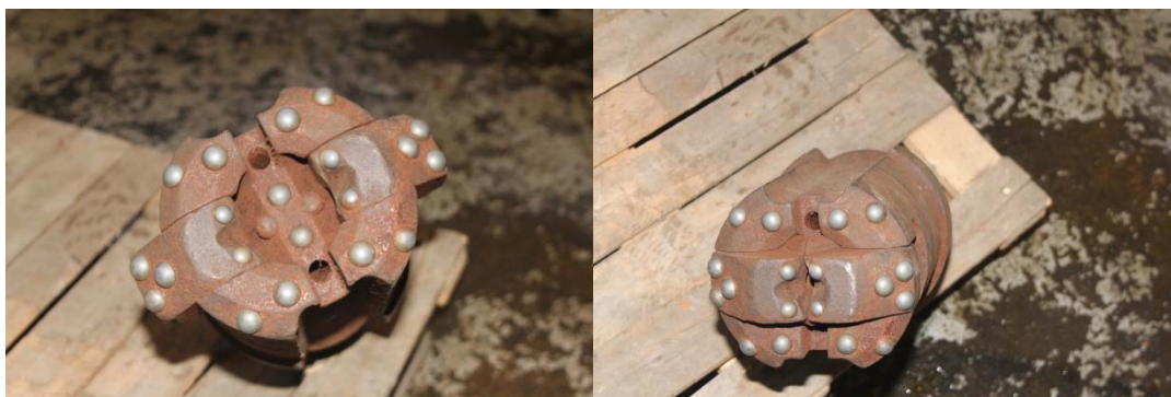
Figur 16: Til venstre, pilotkrone med vinger som presses ut ved mating og til høyre for opptrekk
