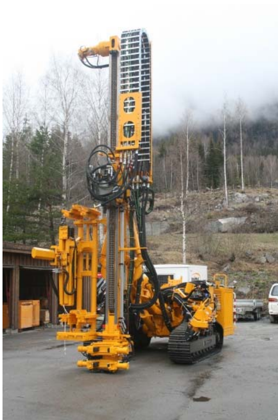
Figur 33: Stagrigg med topphammer og magasin for rørhåndtering
