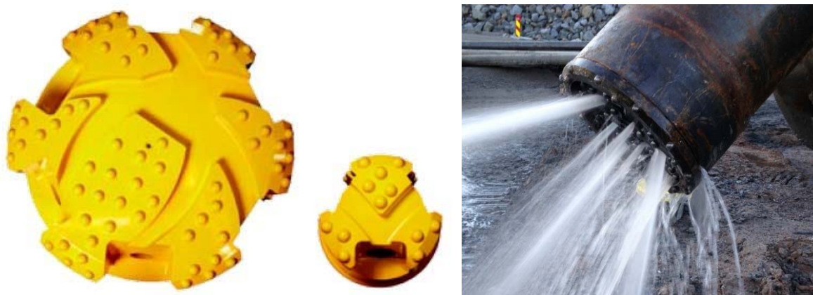
Figur 4-15: Venstre: eksempel Elemex borkrone (Kilde: www.atlascopco.com ). Høyre: bilde som viser pilotkrone trukket inn i forhold til ringkrone og fordeler spylingen framover (Kilde: Geir Veslegard).
