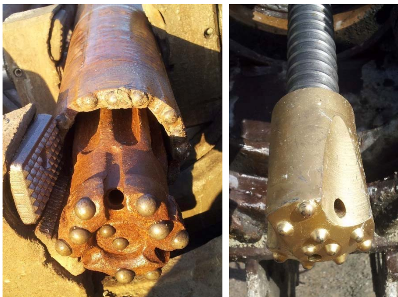
Figur 4-13: Venstre: Toppammer og tykkvegget gjenga foringsrør (OD 114) med sentrisk ringkrone (Ø120 mm) benyttet ved boring i felt E på forsøksfelt for stagboring. Høyre: Toppammer og selv borende stag med bergkrone benyttet ved boring i felt A på forsøksfelt (Lande, 2015).
